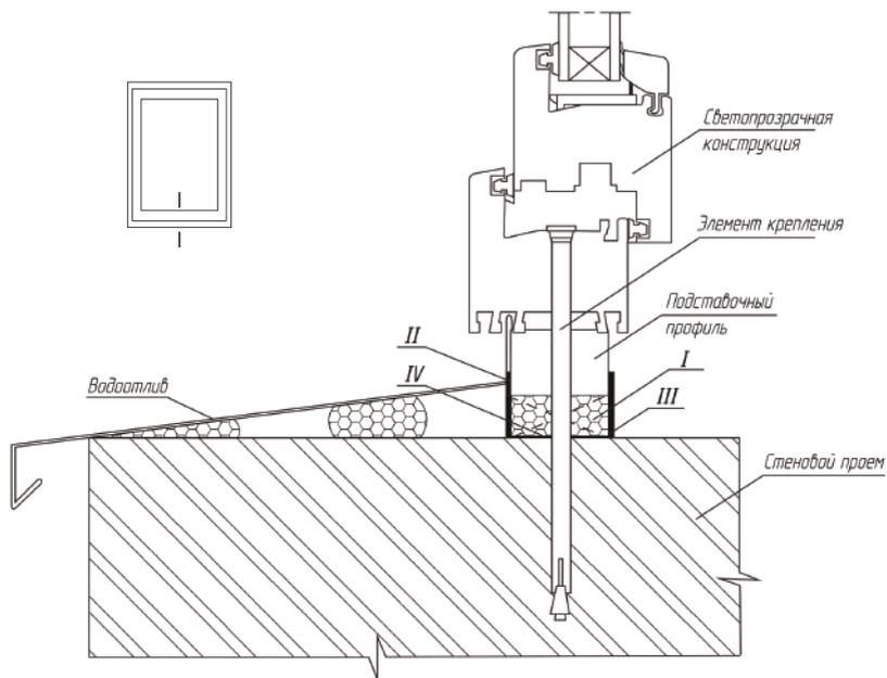
I — центральный тепло-, звукоизоляционный слой (монтажная пена)
