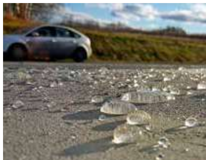
Капля воды на не смачиваемой поверхности дорожных конструкций («Биддинг-эффект»)
